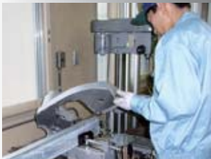
切断機によりアングルの作成
